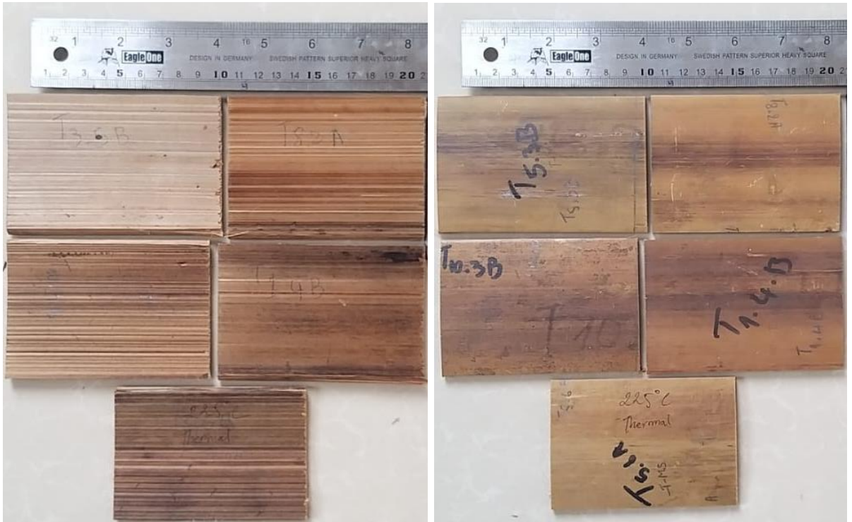
(b) ຕົວຢ່າງໄມ້ປ້ອງທີ່ຜ່ານການອົບຮ້ອນ 225°C ແລະ ຖືກວາງໄວ້ໃນອາຄານ
